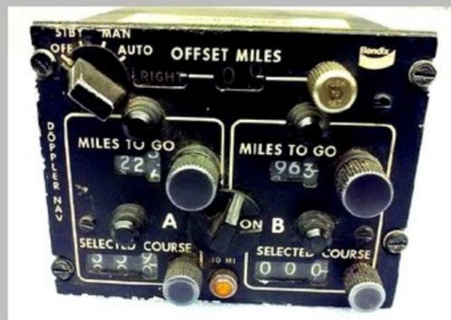
Bedien-Panel im Cockpit, für die Bendix- Navigationsanlage die **ohne** Bodenstationen auskam !
